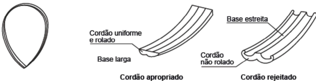
Figura 5 - Aparência do cordão final de solda quando retirado
